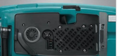
Исключите контакт оператора с токсичной отработанной водой и предотвратите засорение шлангов, используя удобный фильтрующий мусоросборный бак.
